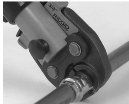
Slika 6 – Postavljanje vilica u obliku škara oko umetka
