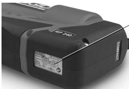
Figur 2 – Maskinens serienummer – inringade siffror anger år och månad för tillverkningen. (YY = år, MM = månad).
