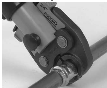
Figura 6 – Collocamento di ganasce di stile a forbice intorno al raccordo
