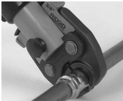
Slika 6 – Postavljanje makazastih čeljusti oko priključka
