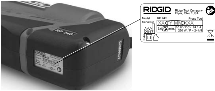
Figur 2 – Serienummer – Opmærkingen (cirkel) angiver produktionsåret og -måneden. (YY = år, MM = måned).
