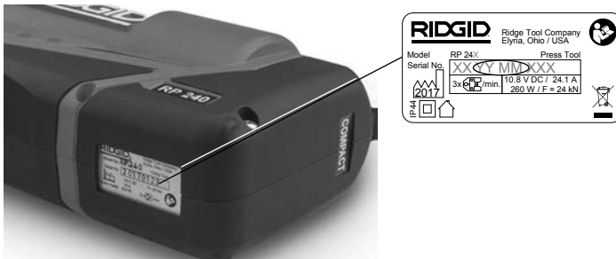
Abbildung 2 – Seriennummer - Die eingekreisten Ziffern geben Jahr und Monat der Herstellung an. (YY = Jahr, MM = Monat).
