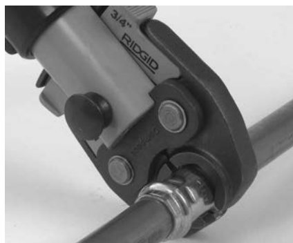
6-сурет – Қайшы тәрізді қармауыштарды фитинг айналасына орналастыру
