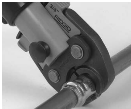
Figura 6 – Așezarea fălcilor tip foarfece în jurul fittingului
