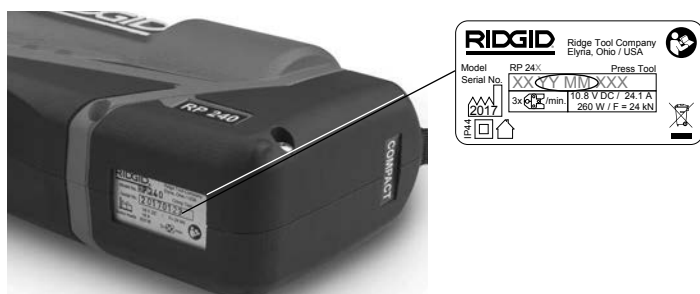
Obrázok 2 – Výrobné číslo zariadenia - Zakrúžkované číslice znamenajú rok a mesiac výroby. (RR = rok, MM = mesiac).
