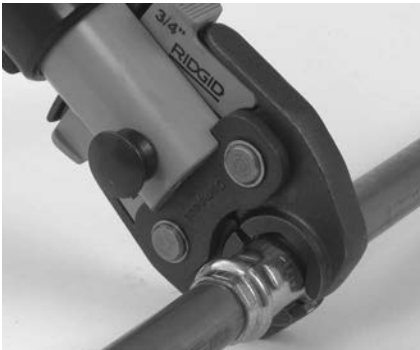
Εικόνα 6 – Τοποθέτηση σιαγόνων τύπου ψαλιδιού γύρω από τον σύνδεσμο
