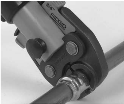
Figuur 6 – Aanbrengen van schaarbekken rond fitting
