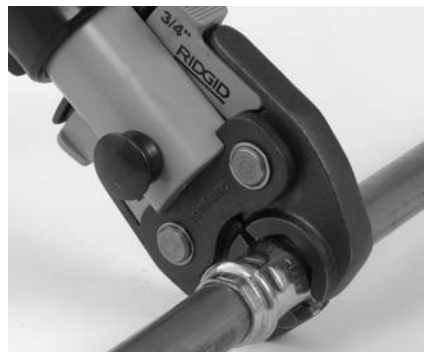
Figura 6 – Colocación de la mordaza tipo tijera para que encierre el acoplamiento
