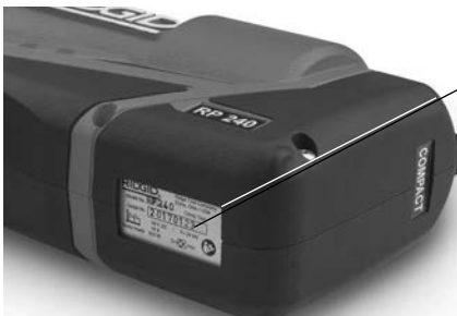
2-сурет – Құрылғының сериялық нөмірі - Дөңгеленген сандар өндірілген жылы мен айын көрсетеді. (ЖЖ = жыл, АА = ай).
