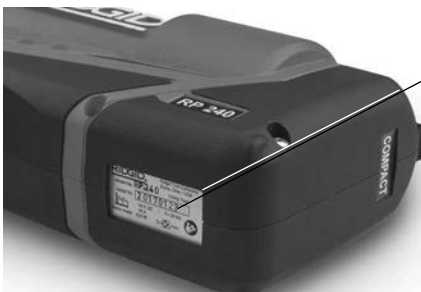
Şekil 2 – Makine Seri Numarası - Daire içindeki rakamlar üretim yılını ve ayını gösterir. (YY = yıl, AA = ay).
